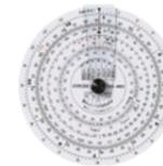
各種材料の比重が分かれば、形状(板・管・棒・パイプ等)による重量算出ができる、技術者向けの計算尺。
